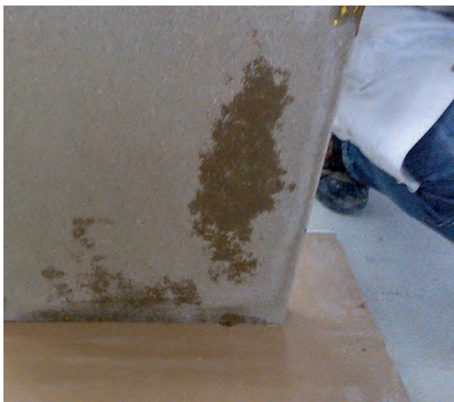
Ilustračné foto: hĺbkový prienik impregnácie betónovou dlaždicou
