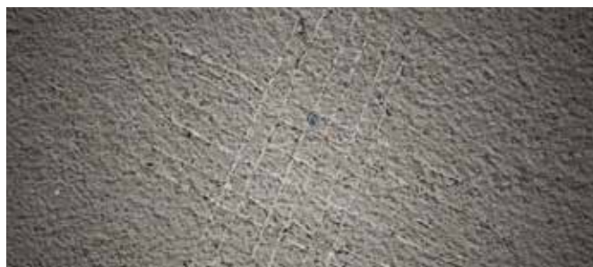
Miesta križenia sú čisté a bez vylomení → skúšaný podklad je OK
