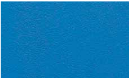
Muster 3: PU Versiegelung QS-Abstreuung 0,1-0,2 mm
