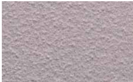
Muster 8: PU Beschichtung QS-Abstreung 0,3-0,8 mm
