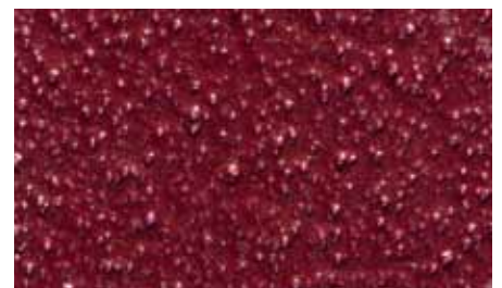
Muster 6: EP Beschichtung QS-Abstreuung 0,6-1,2 mm
